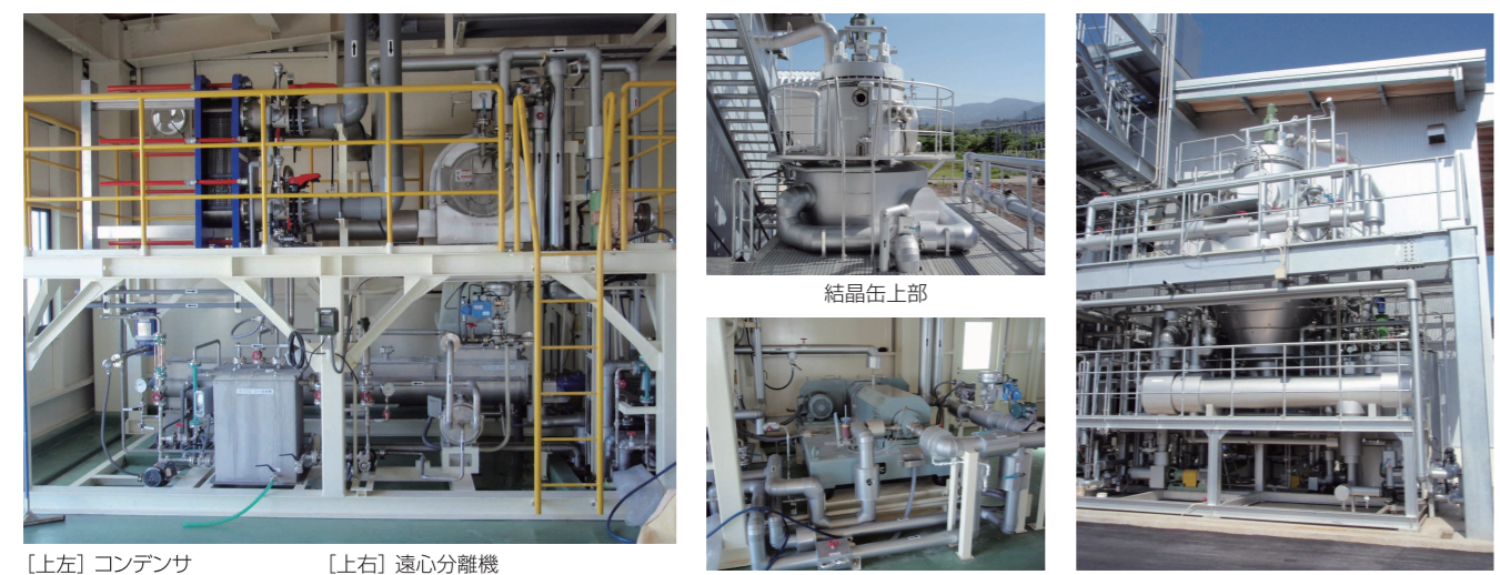
[上左] コンデンサ [上右] 遠心分離機 [下奥] フィーダ [下前] シール水タンク及びポンプ類 デカンタ [手前下] 加熱器 [奥] 結晶缶
